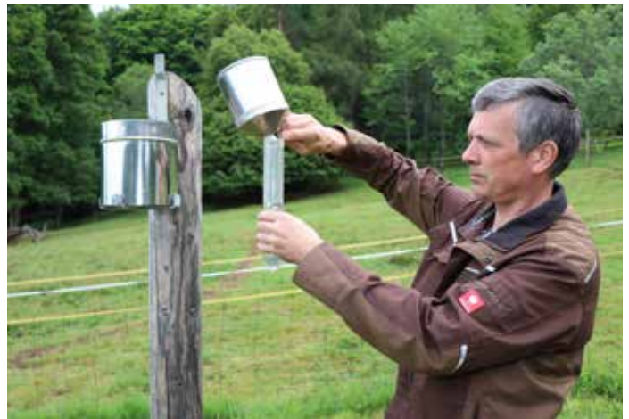
Ludwig Höcker misst in der Klimastation Waldhäuser die Niederschlagsmenge eines Tages. Daneben werden dort seit 1970 auch Temperaturen, Windgeschwindigkeiten oder Schneedichten erfasst. Foto: Gregor Wolf
