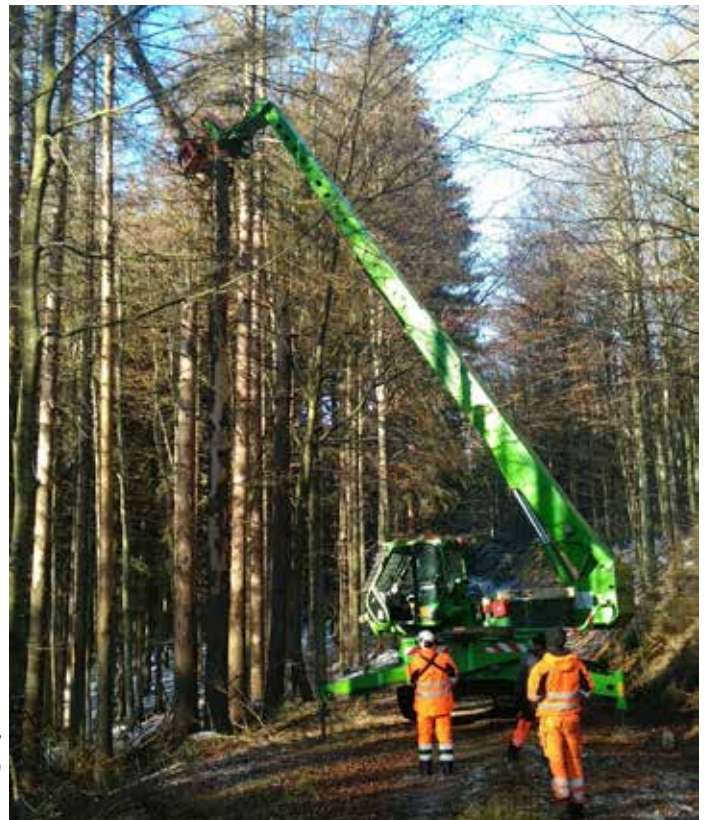
Bäume müssen bei der Verkehrssicherung nicht zwangsweise komplett gefällt werden. Im Bereich Mittelsteighütte hat ein Spezialkran ökologisch wertvolle Hochstümpfe erzeugt. Foto: Martin Plechinger
